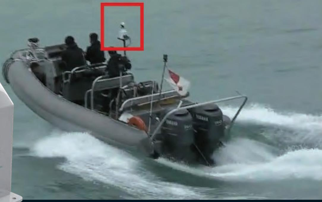
上方のスキャンヘッドに内蔵したミラーに、下方のボディに内蔵したカメラを向けて、ミラーの向きをコントロールして撮影方向を変えるシステムです。ユニークなリンク機構によってミラーのみを駆動するため、計測機器や電装系は固定となっており、超高速で高精度に計測が可能であり、高い耐久性や信頼性も確保しています。
